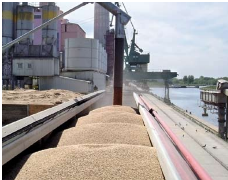
Ein speziell konstruiertes Verloaderohr sorgt für den direkten und sauberen Umschlag des Getreides vom Silo in den bereitstehenden Güterwagen
