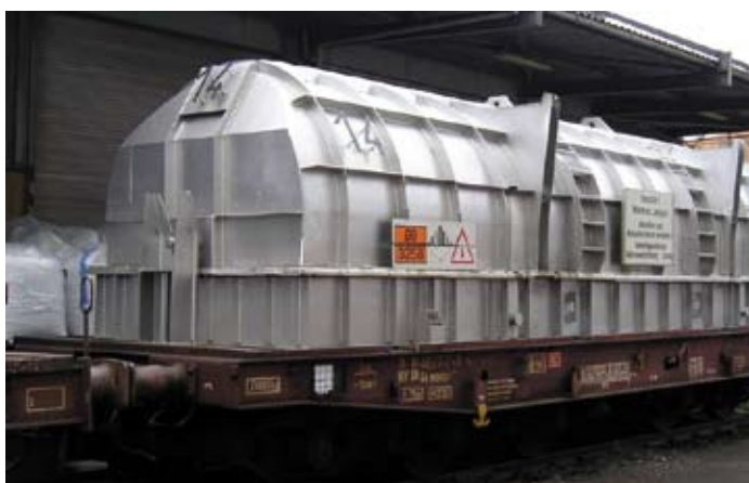
Für die Beförderung der glühenden Gussblöcke wurden die Drehgestell-Flachwagen der Bauart Salmmnps 706 mit speziellen Thermohauben ausgerüstet (l.), für den Transport der kalten Stahlblöcke mit besonders stabilen Seitenrungen (r.)
