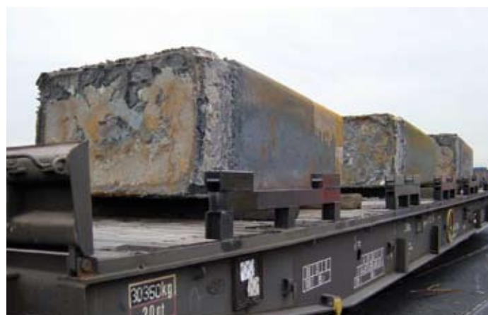
Für die Beförderung der glühenden Gussblöcke wurden die Drehgestell-Flachwagen der Bauart Salmmnps 706 mit speziellen Thermohauben ausgerüstet (l.), für den Transport der kalten Stahlblöcke mit besonders stabilen Seitenrungen (r.)
