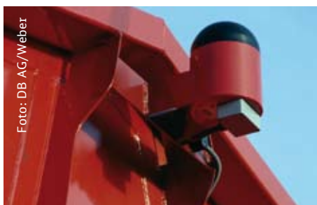
Vielfältig einsetzbar: an den Wagen angebrachte GPS-Geräte
