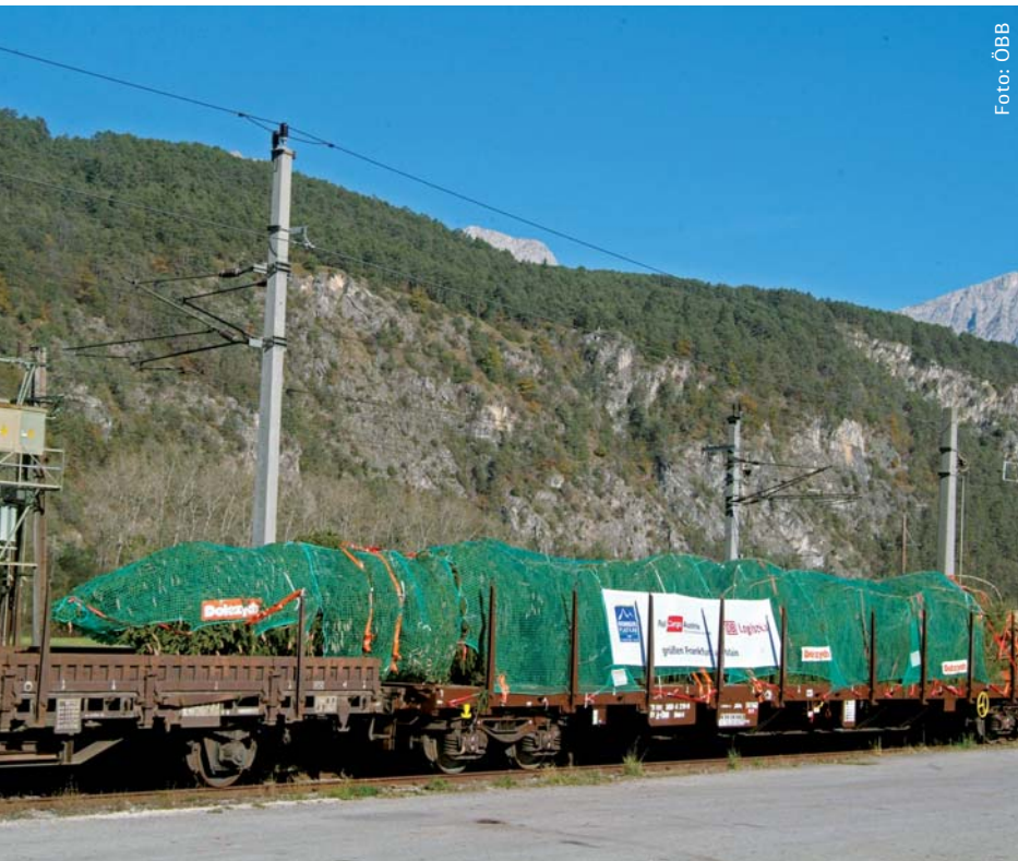
Für den Bahntransport musste die 32 Meter lange Fichte auf drei Wagen verladen werden
