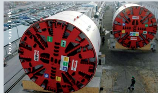
Foto: Rainer Kellers Warten auf ihren Einsatz: zwei gigantische Tunnelbohrmaschinen
