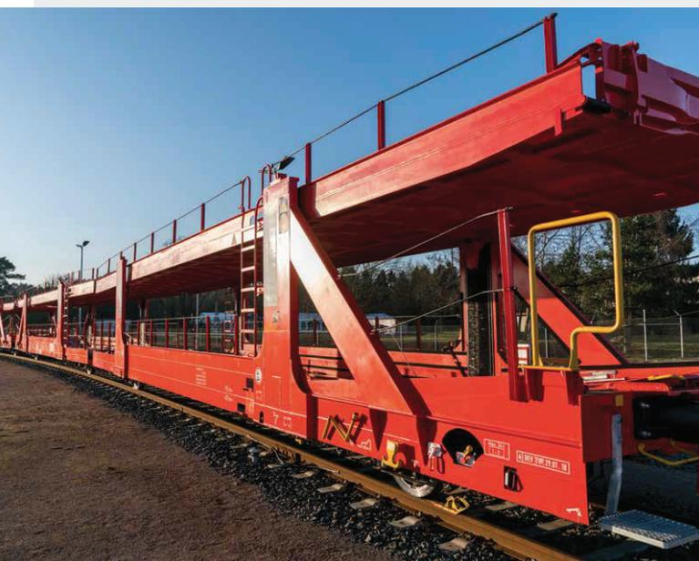
— Der Wagen ist 33 Meter lang und mit Telematik sowie einem flexiblen Ladungssicherungssystem ausgestattet.
